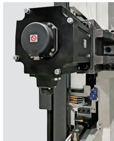
監控螺桿溫升、振動、智慧潤滑 與壽命預診的智慧螺桿
