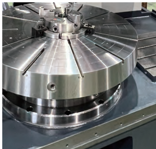
高負載超精密液靜壓旋轉工作台
